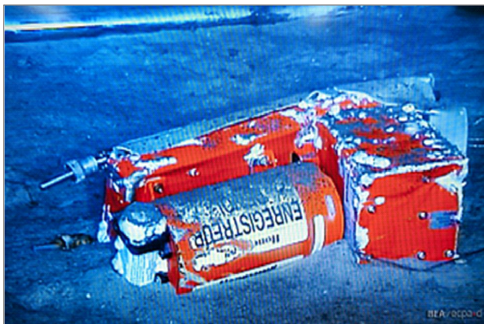
Figure I-5-5. Enregistreur de bord d'un Airbus A330 photographié à 3 900 m de profondeur dans l'océan Atlantique (accident survenu en 2009)
